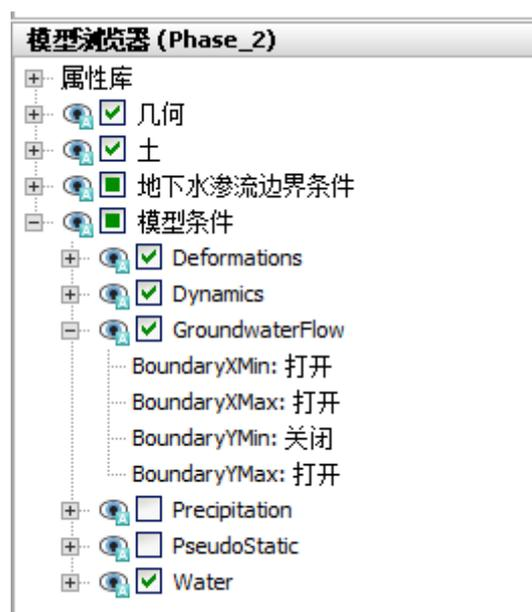
图 5 初始阶段的地下水流动边界条件
